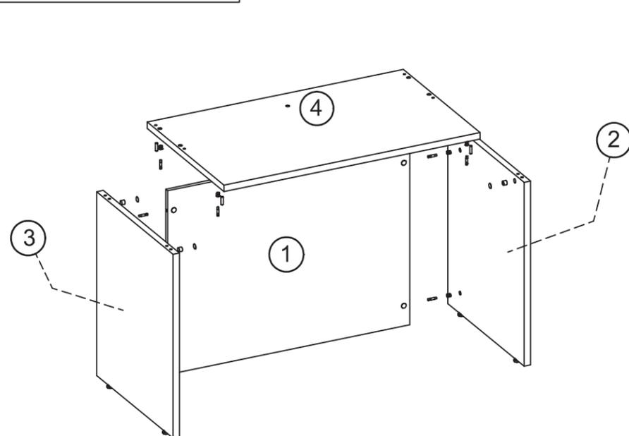
PARA FACILITAR A MONTAGEM INICIE FIXANDO FUNDO INFERIOR (1), LATERAL ESQUERDA INFERIOR (3), LATERAL DIREITA INFERIOR (2) E TAMPO INFERIOR (4).
